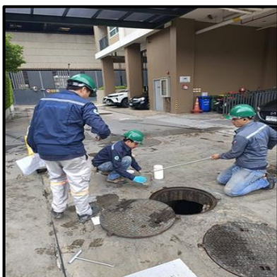
ภาพที่ 1 ภาพการเก็บตัวอย่างน้ำเสียภายในโครงการ
