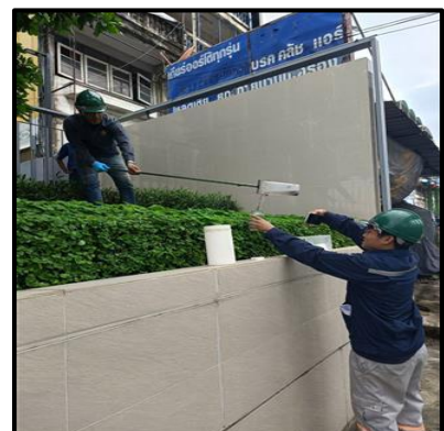
ภาพที่ 1 ภาพการเก็บตัวอย่างน้ำเสียภายในโครงการ
