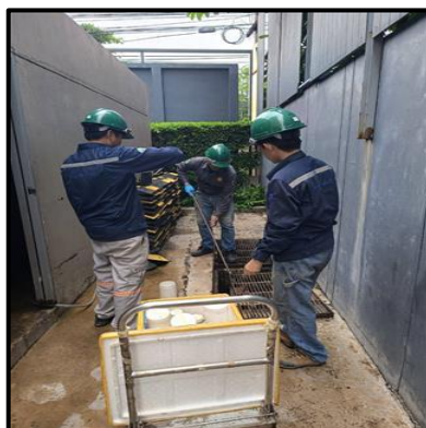
ภาพที่ 1 ภาพการเก็บตัวอย่างน้ำเสียภายในโครงการ
